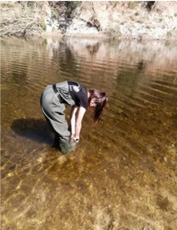
**Figura 3.** Toma de muestras de plaguicidas en agua mediante el empleo de botellas de cristal.
